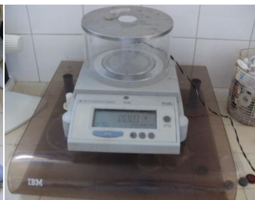
Figure32: Balance à précision et pompe à vide (0.001g; Denver Instrument Company, modèle TR-403)
