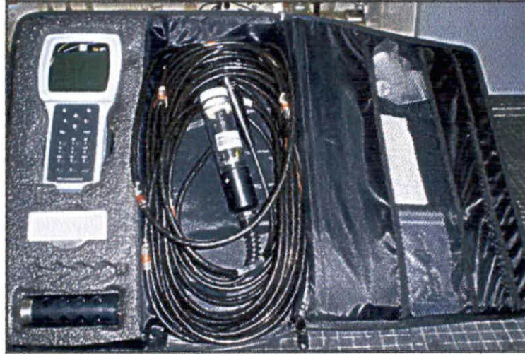
Figure 14 : Analyseur multi paramètres servant à mesurer les paramètres physico-chimiques (température, pH et oxygène dissous...).
