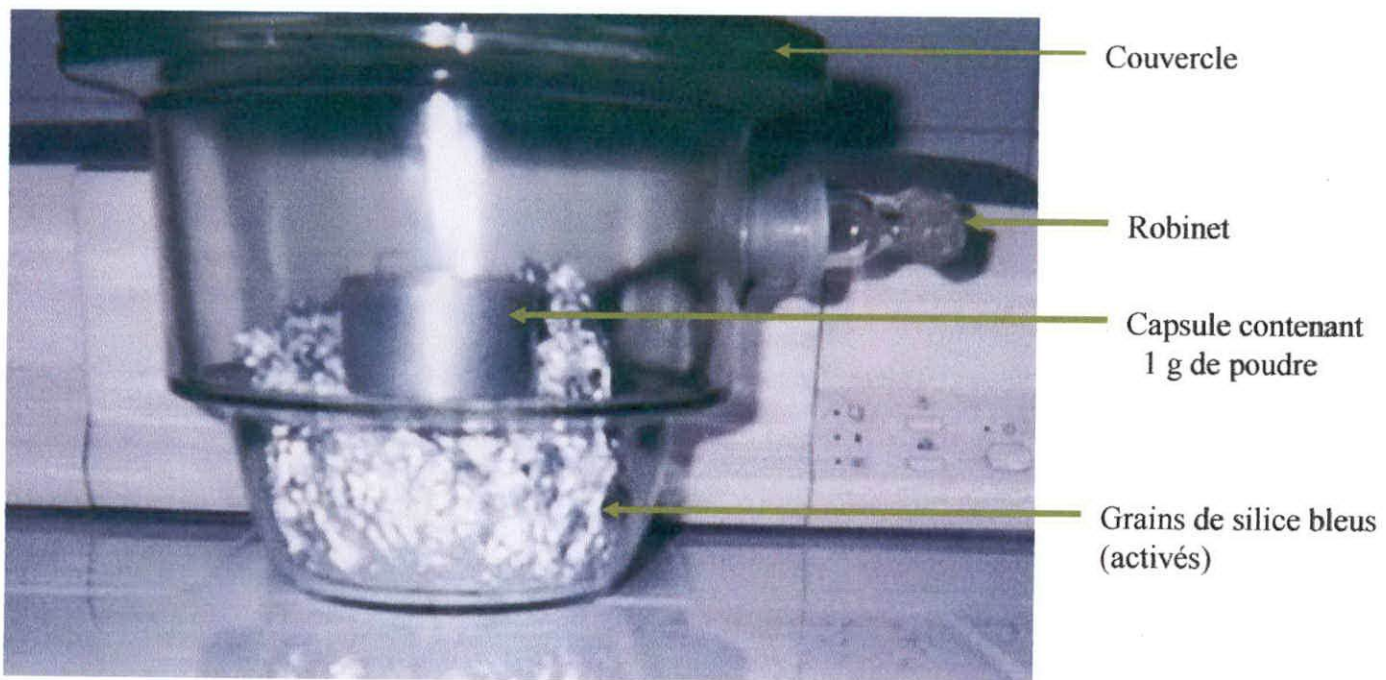
Figure 02 : Refroidissement de nos échantillons dans un dessiccateur avec des grains de silice
