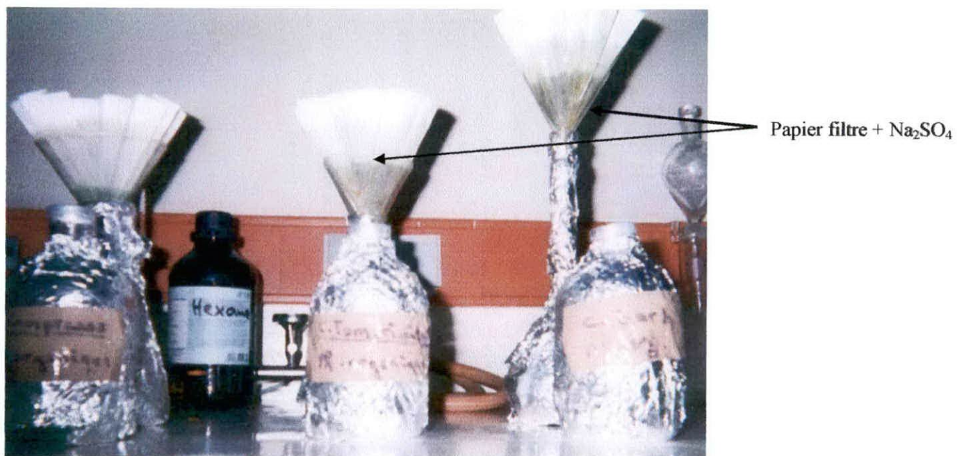
Figure 06 : La filtration de phases organiques obtenues en présence de Na 2 SO 4
