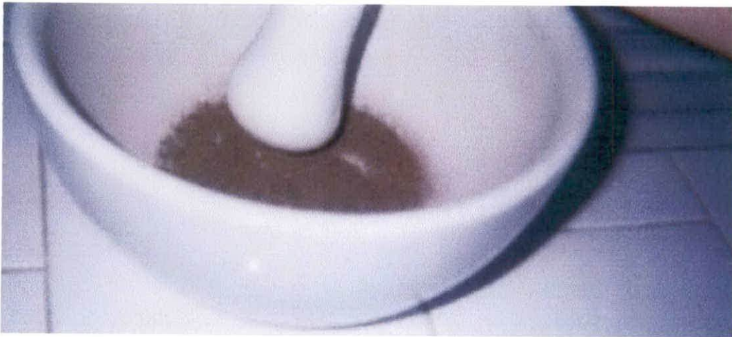
Figure 01 : Broyage des algues séchées dans un mortier.
