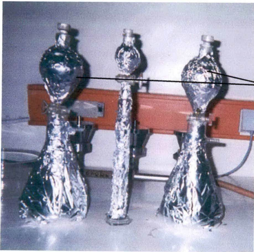
Figure 04: La décantation des résidus obtenus dans une ampoule à décanter
