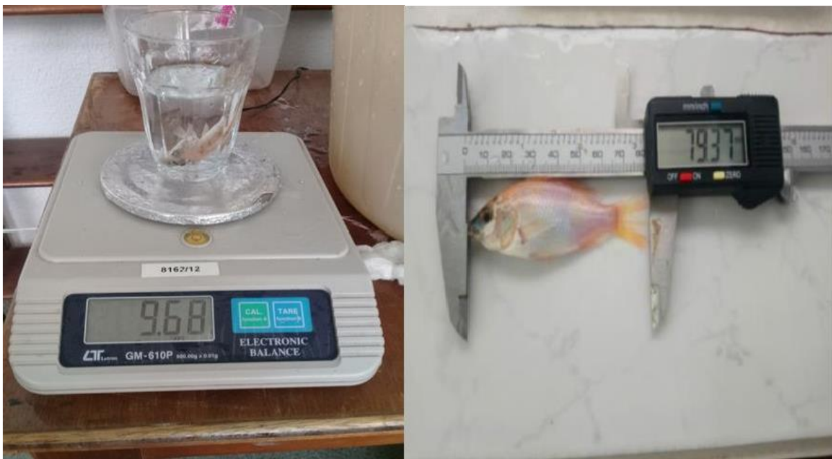
Figure 2.2 : Balance électronique (à gauche), et pied à coulisse (à droite) Pour la mesure du poids et de la taille des alevins.
