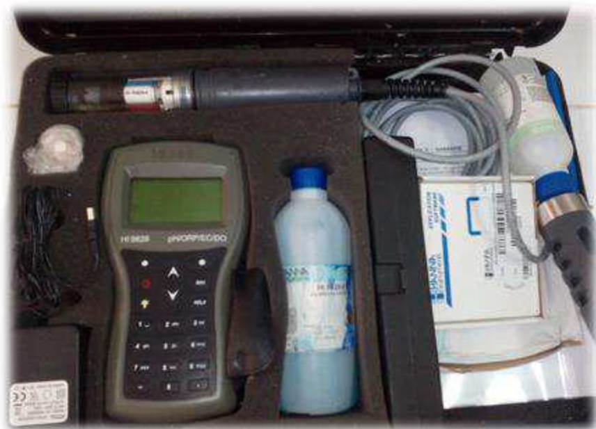
Figure III.3 : Valise multi-paramètres de type HANNA.
