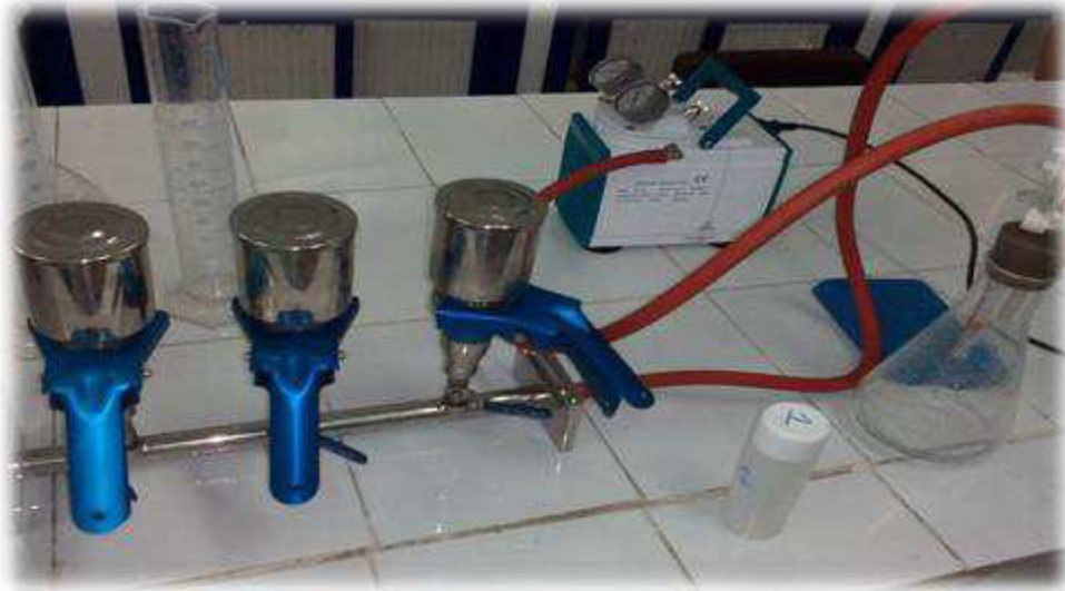
Figure III.4 : Dispositif de filtration (pompe sous vide).
