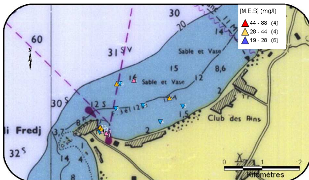
Figure 2.5.4. Répartition ponctuelle des teneurs en matière en suspension (mg/l) des eaux de fond de la baie d'EL Djamilia (Janvier 2009)
