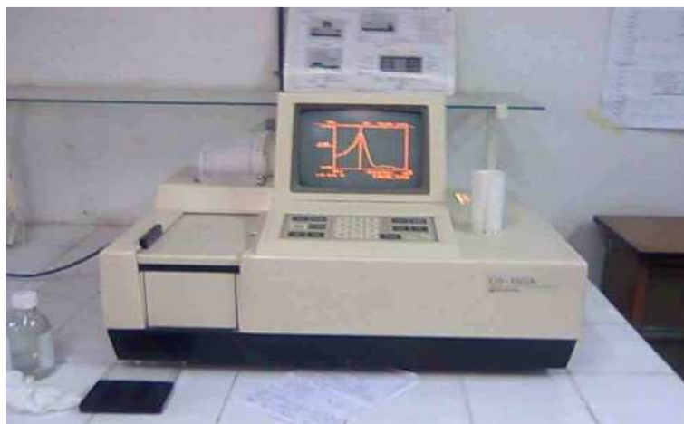
Photo n 17 : spectrophotomètre UV VIS
