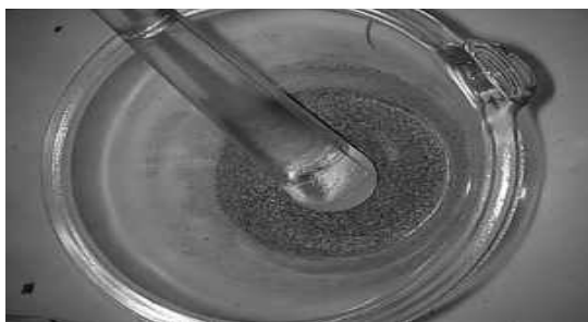
photo n5 : broyage de l'echatillon dans un mortier
