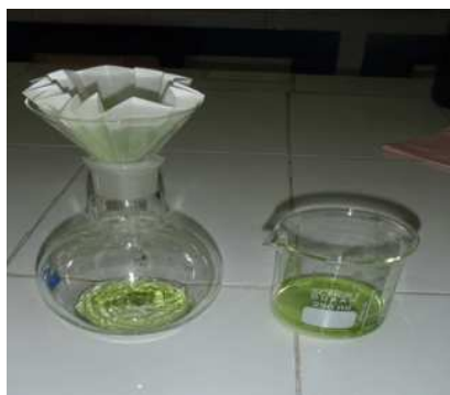
Photo N11 : filtration du résidu en présence de \text{Na}_2\text{SO}_4
