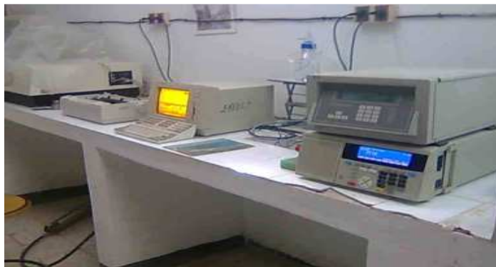
Photo n 16 : appareil d'HPLC utilisée (U.V VIS).
