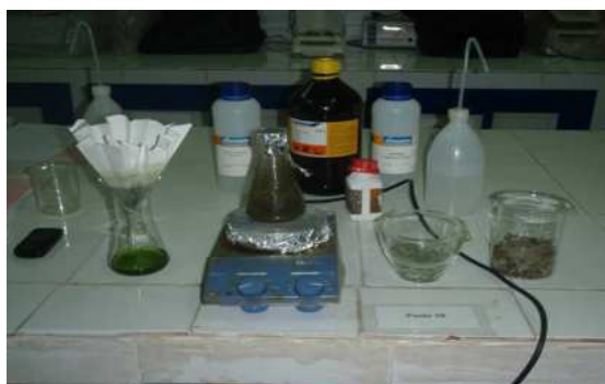
Photo N6 : étape de percolation et filtration
