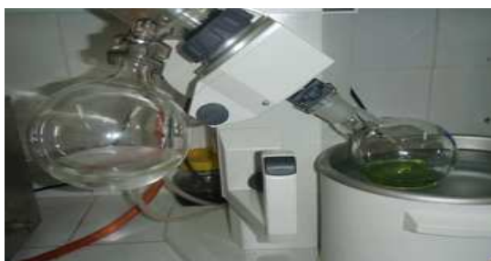
Photo N12 : rotvaporation et recuperation des solvants
