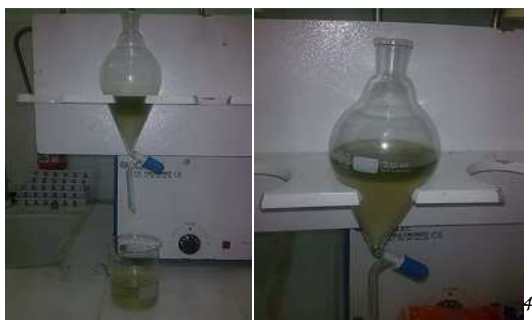
Photo N8: décantation dans une ampoule à décanter a fin de séparer la phase organique et phase aqueuse
