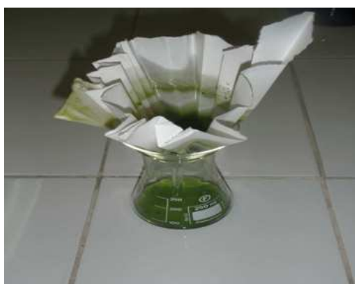
photo N7 : filtration de residu sur papier filtre
