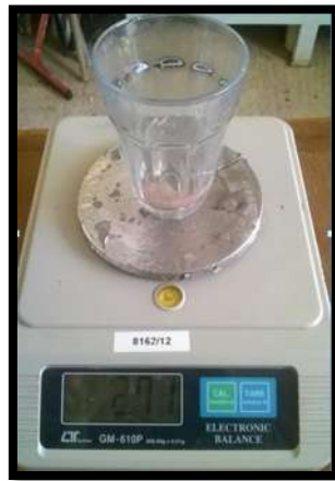
Figure I.1: Pesée des alevins de Tilapia avec une balance électronique de marque LUTRON (GM-610P)
