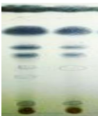
Figure III.45 : Chromatographie sur couche mince de l'huile des têtes d'espadon De gauche à droite : AGPI de la série \omega 3 commercial, huile de tête d'espadon.
