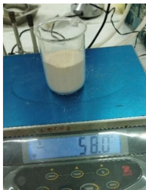
Figure III.38 : Pesée du chitosane produit à partir de 400 g des carapaces de crevettes
