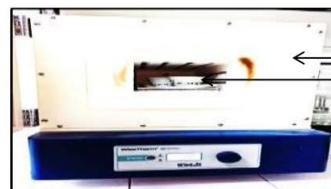
Incineration des échantillons dans le four à moufle
