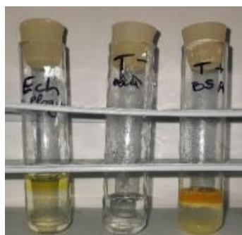
Figure III. 42 : Résultat du test à la xanthoprotéine.
