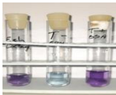
Figure III.41 : Mise en évidence de la présence du collagène avec la méthode de biuret.
