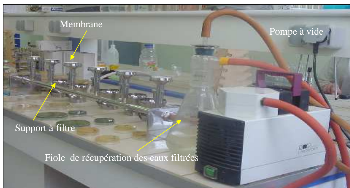
Dispositif de filtration sur membrane (Rampe de filtration de type Sartorius)
