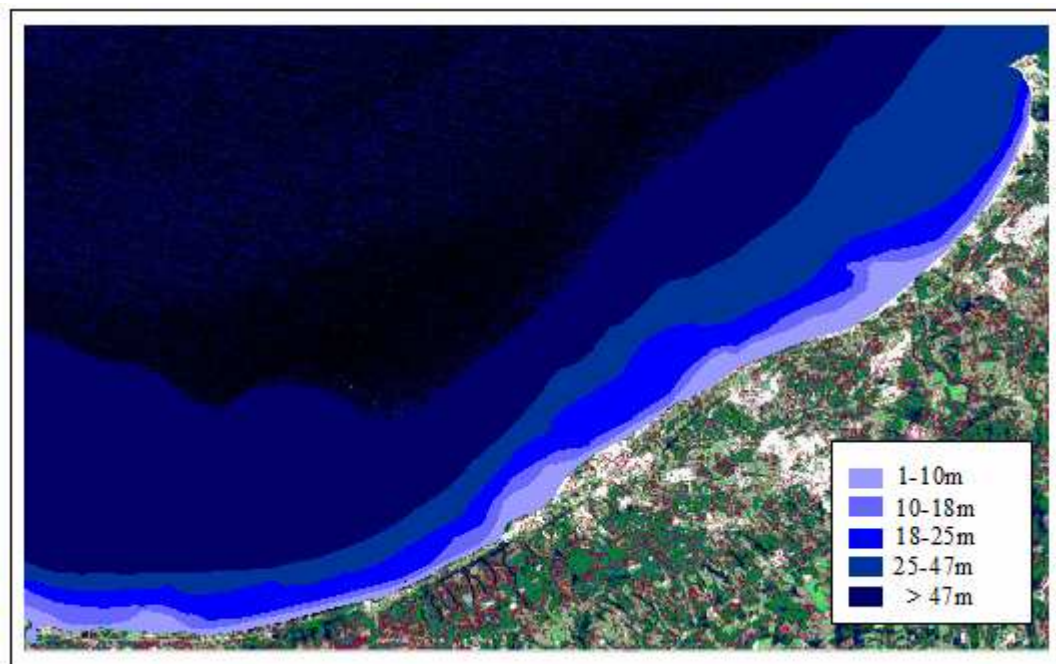
Figure IV.18 : Carte bathymétrique de la baie de Bou-Ismaïl extraite à partir d'une image satellite LANDSAT-TM1 (Al Sid Chikh.S et Lainser.K, 2008)
