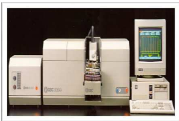
Figure II.15 : SSA automatisé avec Échantillonneur automatique
