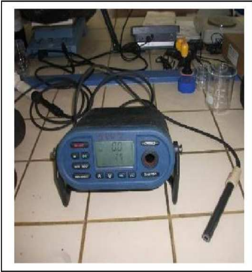
Figure II.1: Oxymètre mètre de terrain de type (WTW Oxi 197 i/set)
