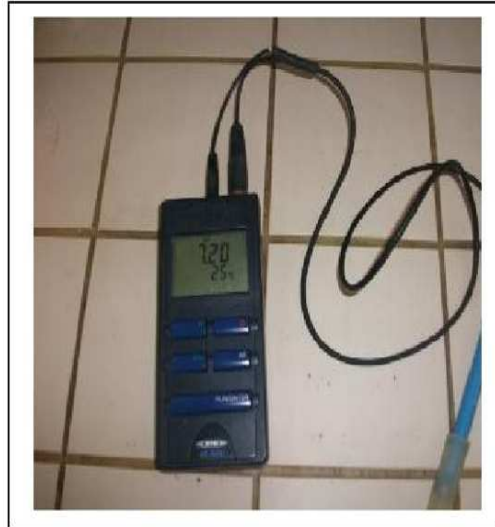
Figure II.2: pH mètre de terrain de marque (WTW pH 315)
