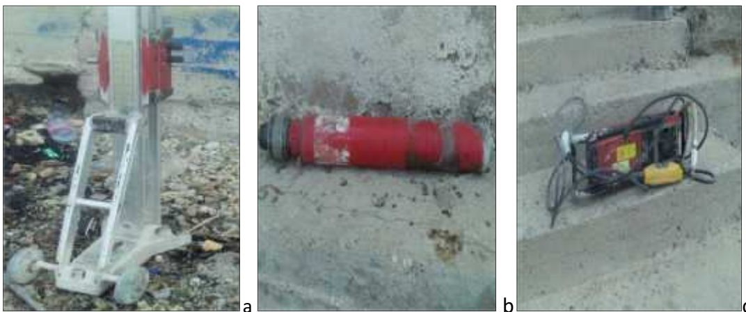
Figure n° 38: Carotteuse équipée : a-bâti; b- carottier; c- moteur
