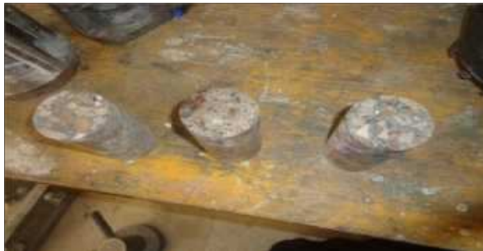
Figure n° 41: Carottes découpées de hauteur 13cm et diamètre 6.5cm
