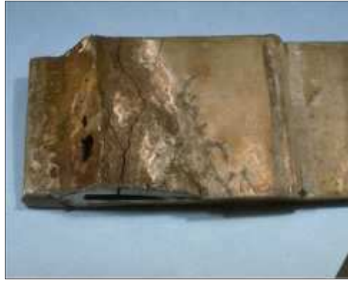
Figure n°15: Fissuration sur métal sous l'effet d'une contrainte
