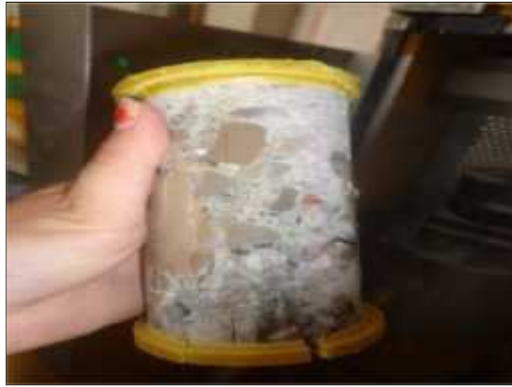
Figure n° 47: Rupture de la carotte sous l'effet de l'écrasement
