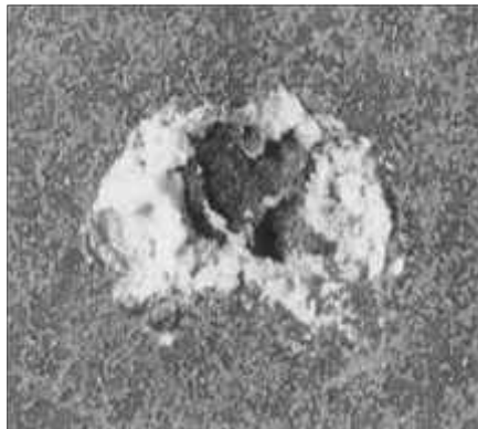
Figure n° 14: Corrosion par piqure
