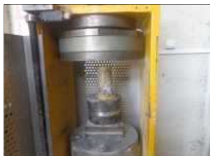
Figure n° 46: Carotte mise dans la presse à béton
