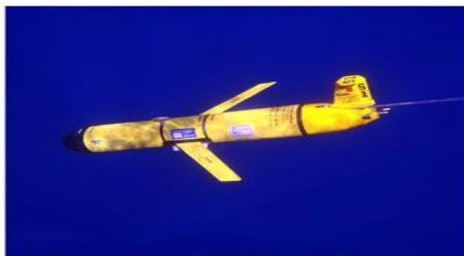
Figure 2. 1 : Glider SLOCUM G2 utilisé lors des missions ABACUS (Source : Cotroneo et al., 2019).
