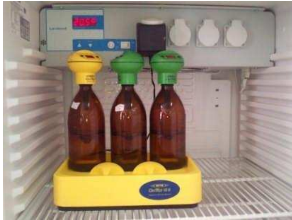
Figure 11 : Dispositif de la mesure de la DBO 5 .
