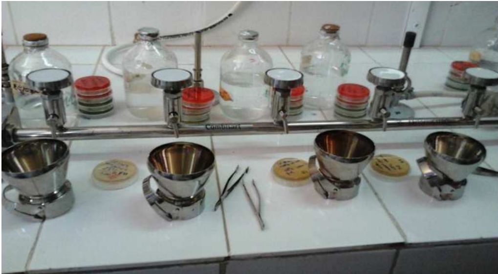
Figure 16 : rampe de filtration.
