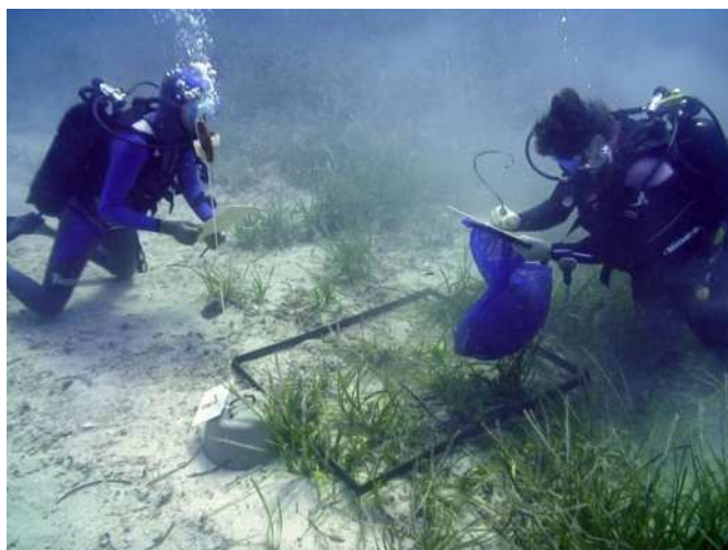
Figure 11. Photo montrant la méthode de mesure du recouvrement en amont de chaque balise.
