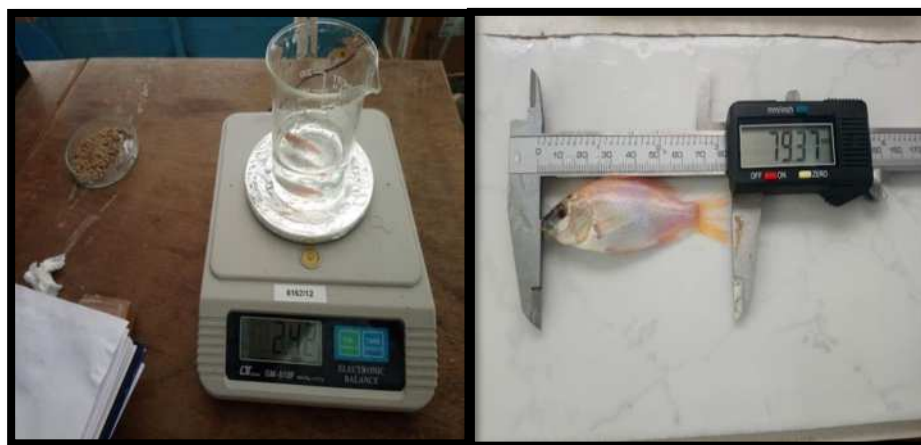
Figure 2.17 : Balance électronique (à gauche), et pied à coulisse (à droite) pour la mesure du poids et de la taille des alevins
