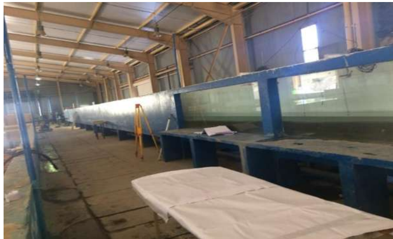
Figure IV-21 : Canal à houle et matériels du laboratoire
