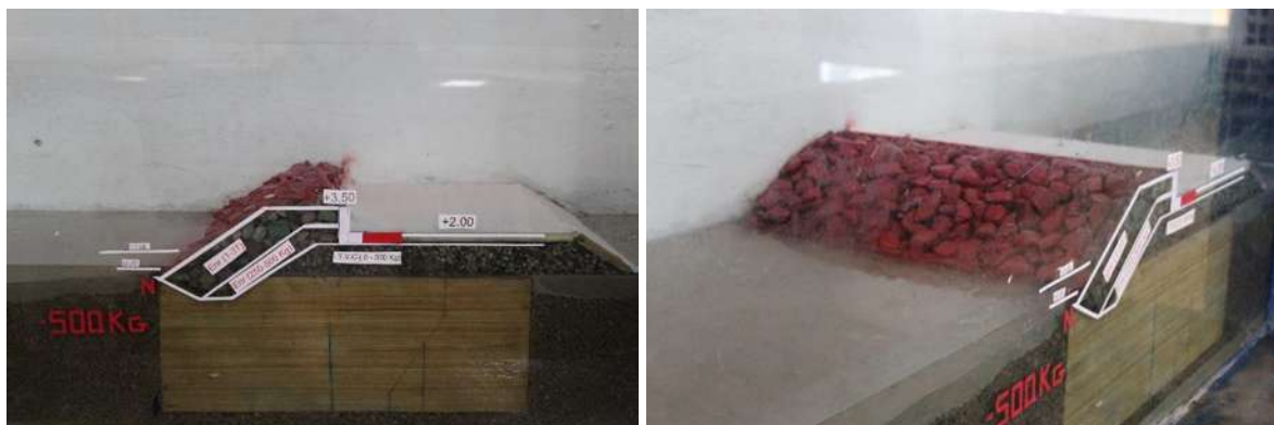
Figure IV-20 : Ouvrage et fonds en canal à houle
