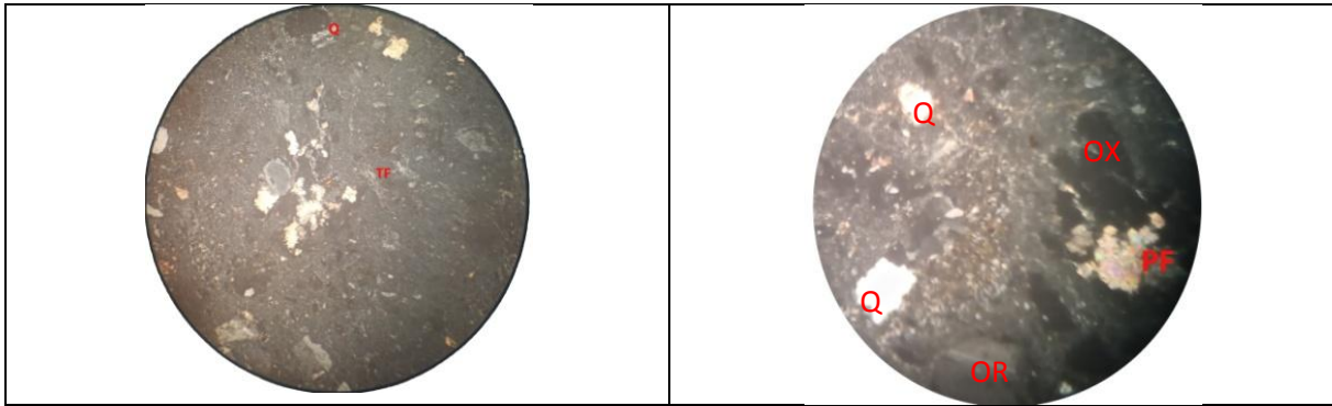
Figure 34 Microphotographie de l'échantillon 02. Orthose (OR), Quartz (Q), Biotite séricitisée (PF). Oxydation (OX). (Gx10), LN
