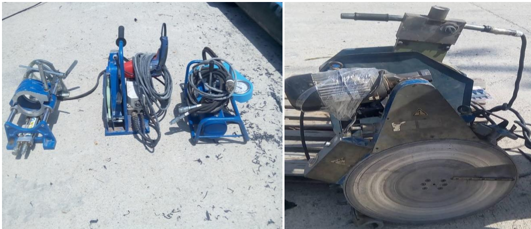
Figure II. 10. Résistance électrique pour le fusionnement des cerceaux (Sahraoui, 2019)
