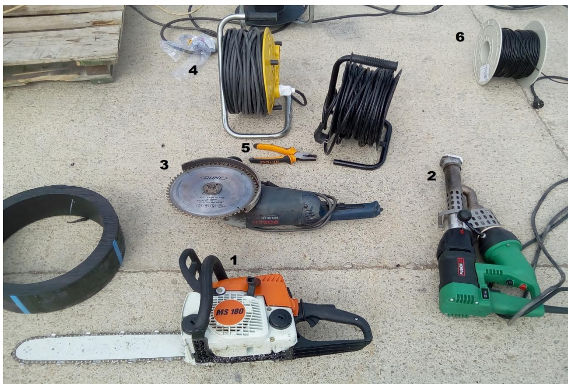
Figure II. 7. Matériel nécessaire pour l'assemblage des cages (sahraoui,2019)
