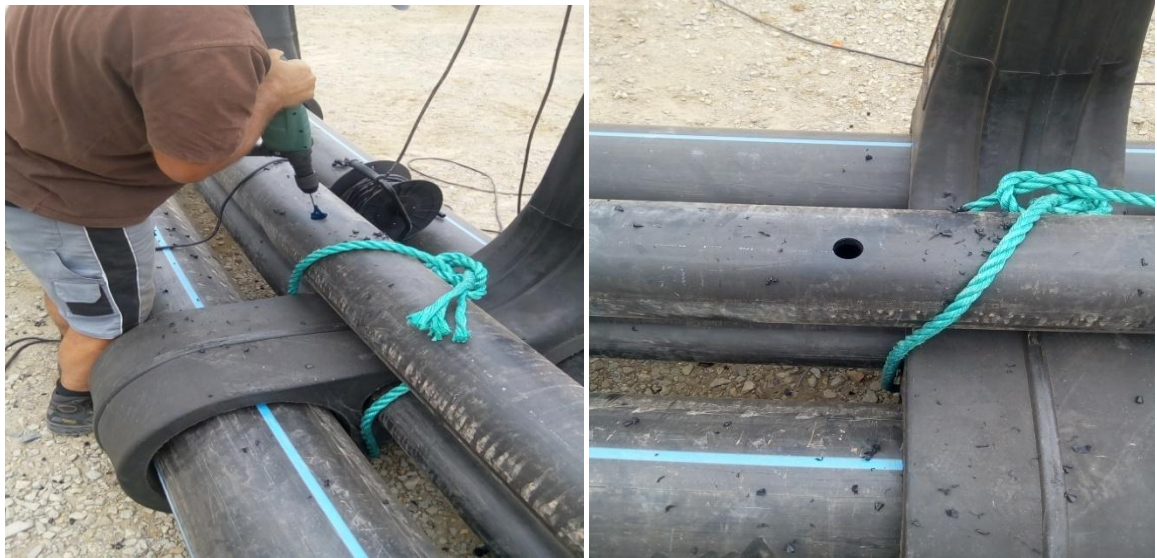
Figure II. 17. Faire des trous sur le sinker tube. (Sahraoui ,2019).
