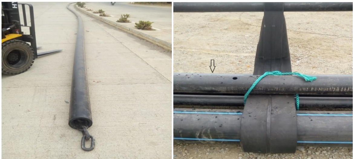
Figure II. 16. Sinker tube est temporairement installé sur la clôture de la cage. (Sahraoui, 2019).
