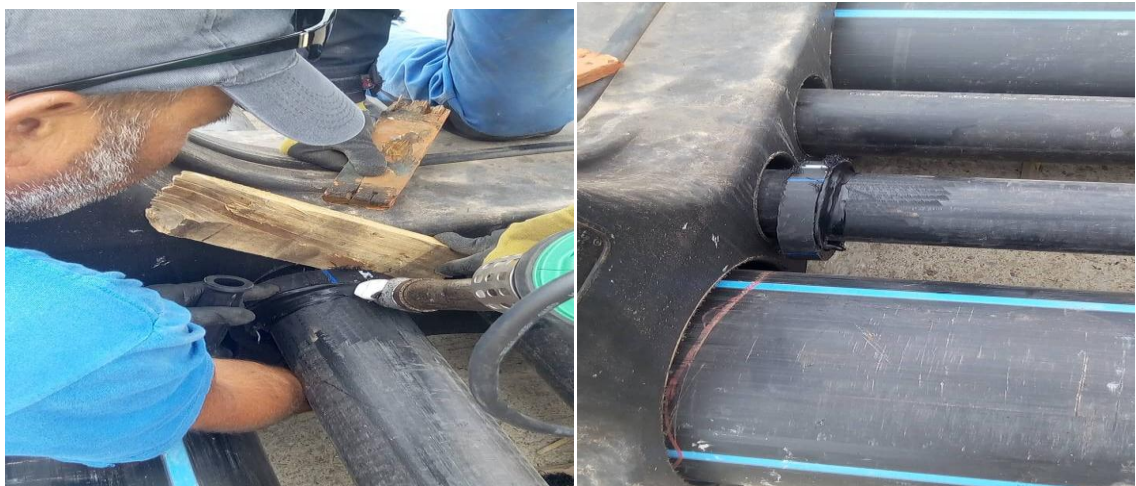
Figure II. 18. Les freins sont soudés sur le tube de la cage à l'aide d'une machine de soudage PEHD (Sahraoui ,2019)
