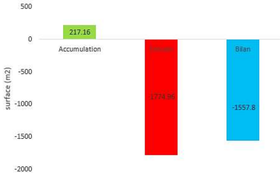
Figure VI.17 : Histogramme du bilan sédimentaire de la côte de Sidi Fredj entre 2002 et 2004.
