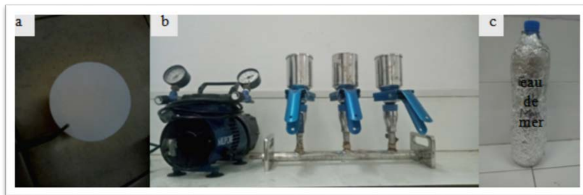
Figure II . 15 : Matériels pour la détermination de la chlorophylle (a) (a: membrane de filtration, b: rampe de filtration, c: bouteille recouverte de papier aluminium)
