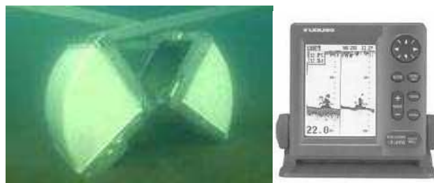
Photo II.2 : la benne VAN VEEN Photo II.1 : échosondeur
