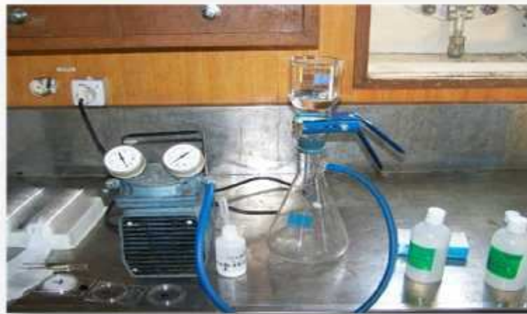
Figure 8: Dispositif de filtration à bord du navire
