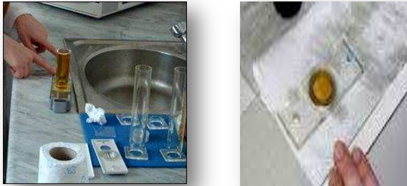
Figure 03 : Sédimentation des échantillons à l'aide des chambres d'Utermöhl.
