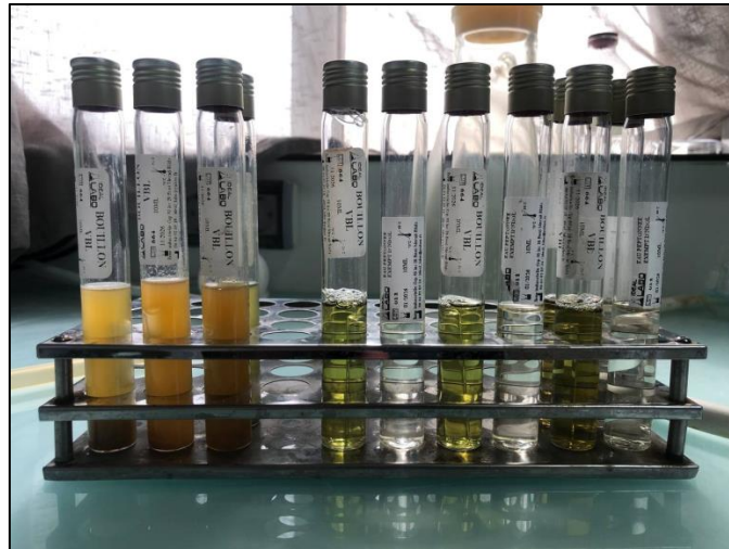
Figure 24 : Photographie montrant douze (12) Tubes NPP (nombre le plus probable) pour la recherche des coliformes fécaux et E. coli.
