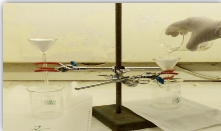
Figure III-7 : Filtration de la solution
