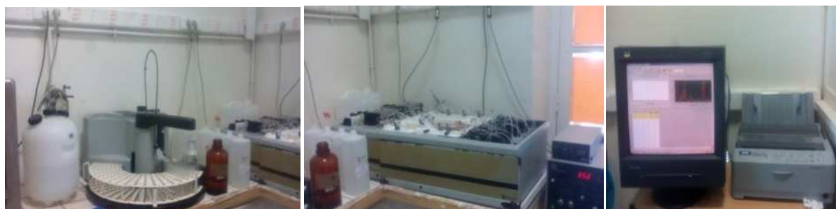
Figure (8): L'Auto Analyser San Plus « SKALAR ».
