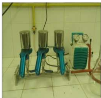
1. Dispositif de filtration (rampe de filtration) muni d'une pompe à vide
