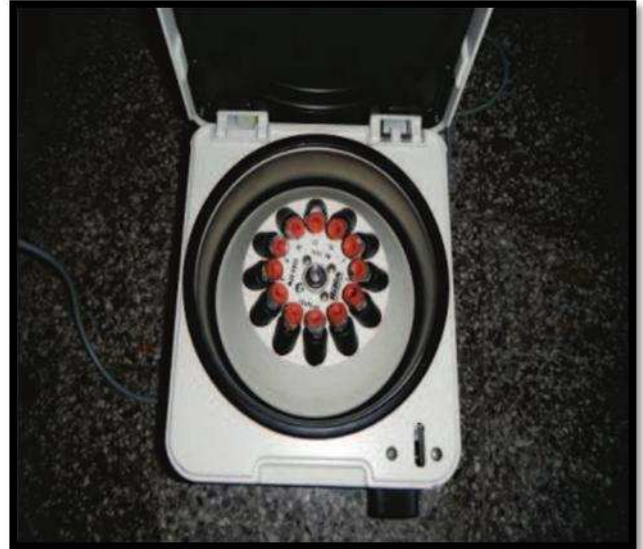
Figure 3.9 : Centrifugeuse Hettich ZENTRIFUGEN de type EBA 30
