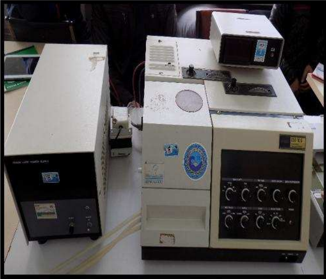
Figure 3.10 : Spectrophotomètre fluorescence de type HITACHI modèle 650-10 S
