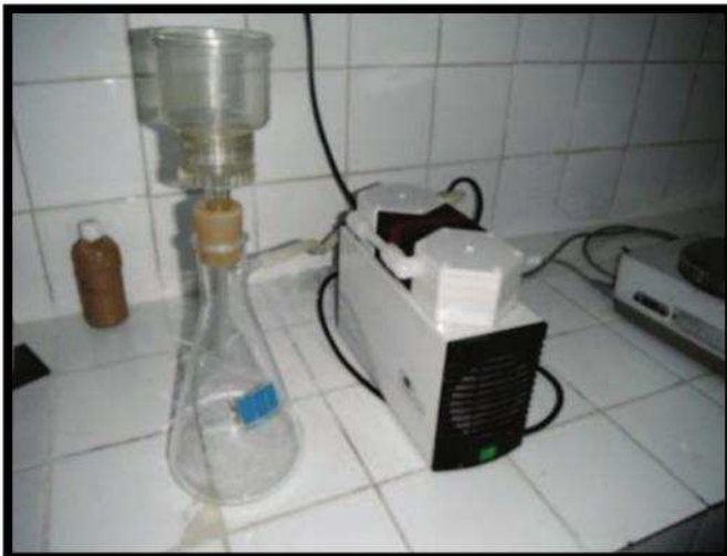
Figure 3.8 : Système de filtration sous vide de marque Millipore® .
