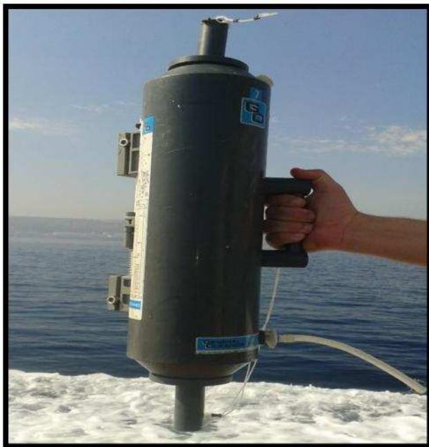
Figure 3.4: bouteille de prélèvement d'eau de mer de type NISKIN
