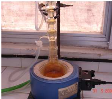
Figure 13: Dispositif de minéralisation sous colonne à reflux.
