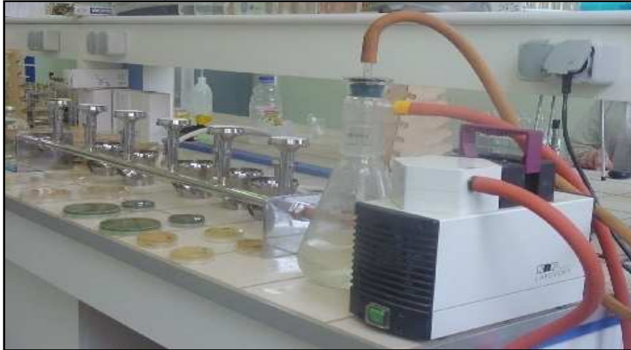
Figure 14: Dispositif de l'appareil de filtration sur membrane.
