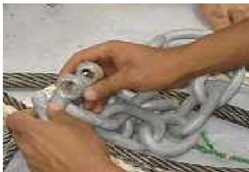
Figure 32 : Image montrant l'introduction de la chaîne dans la manille
