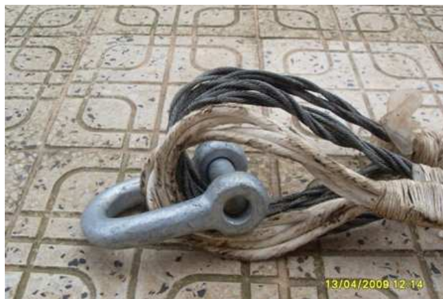
Figure 29 : Image de la manille avec les extrémités des trois Aussières.
