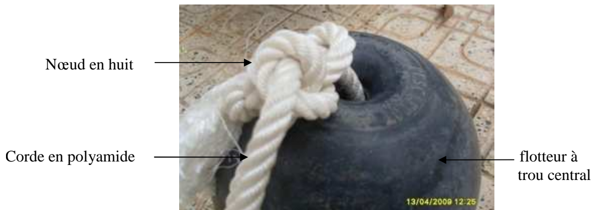
Figure 31 : Image montrant l'amarrage d'un flotteur par un nœud en huit
