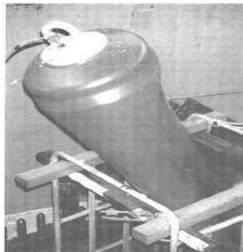
Figure 26 : Ce flotteur s'est aplati sous l'effet de la pression externe.
