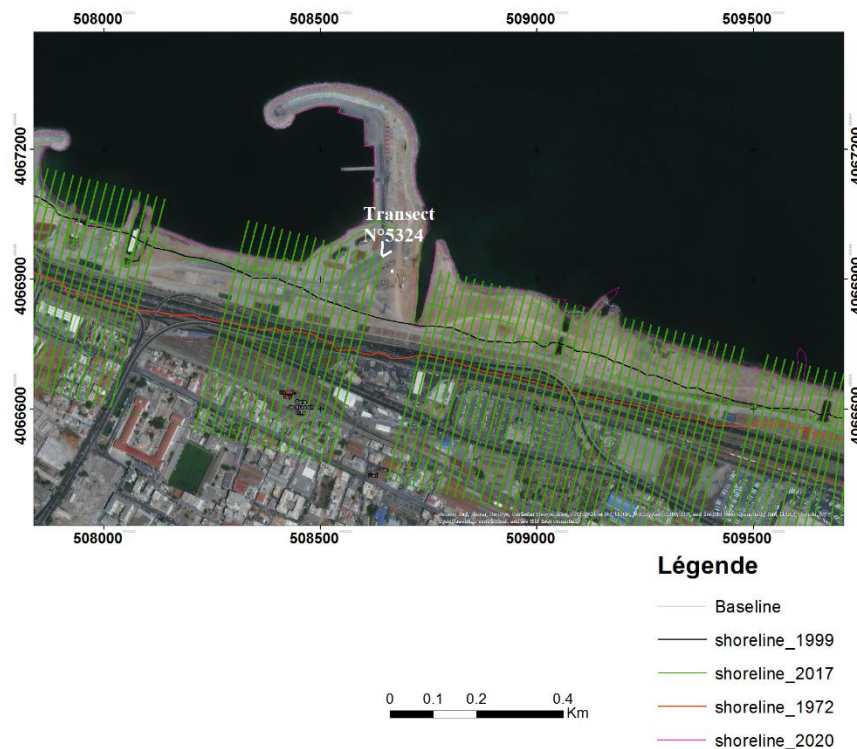
Figure 57: Création des transects espacés de 20 m à partir de code de calcul DSAS.
