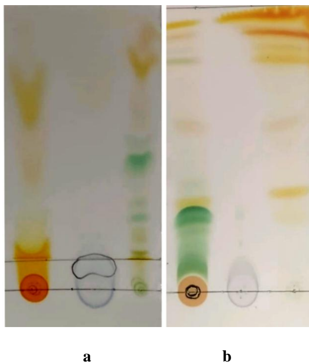
Figure 29: Plaques imprégnées à l'huile de paraffine après migration des différents pigments dans a) système éluant méthanol/acétone/eau et b) système éluant méthanol/acétone
