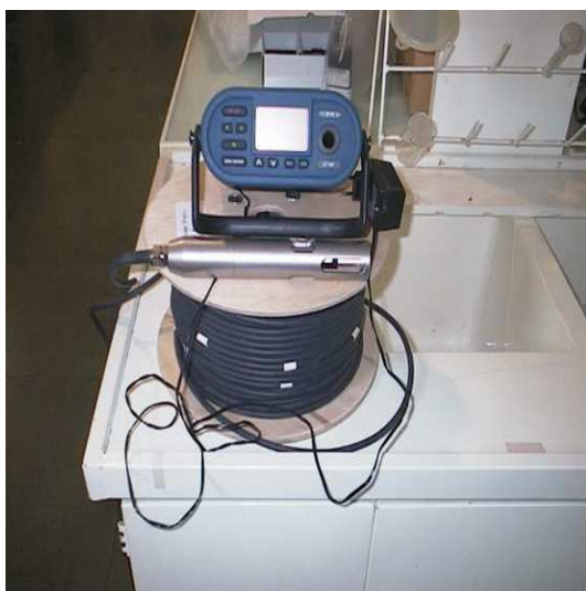
Figure 14: Conductivimètre avec sonde.
