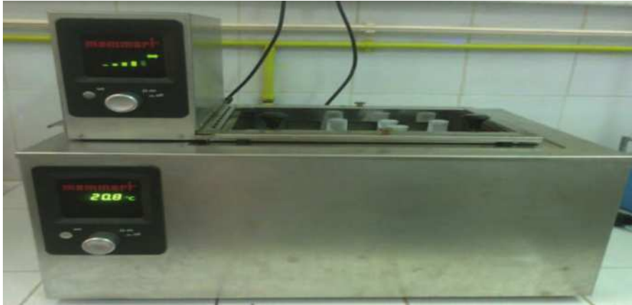
Figure 10: Dispositif à multipostes muni d'un agitateur (modèle Memmert SV 1422) les différents temps d'essais sont: 15,30,60,120,180,240,300,360
