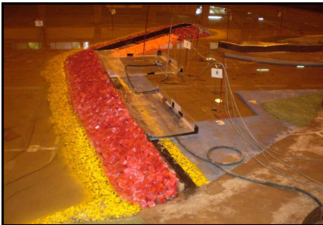
Photo 6: Vue générale de la variante 1 au cours des essais en bassin à houle
