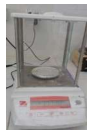
Figure III.5 : La balance de précision de marque OHAUS.
