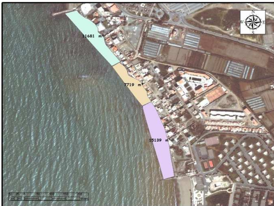
Figure IV-5 : Surface d'injection de la plage Ouest de Sidi Fredj. (Aidoud, Mimouni ; 2009). Le volume de sédiment à draguer au niveau de Sidi Fredj (tableau IV-3) a été estimé au total à 64 418 m 3 .
