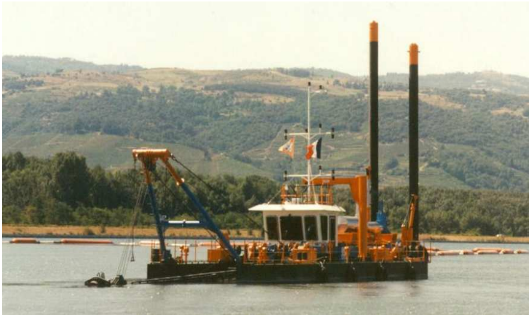
Figure IV-1 : Drague aspiratrice refouleuse stationnaire. (CoDISOD ; 2008).
