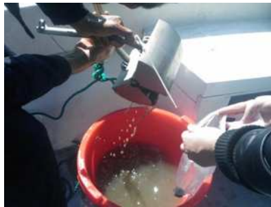
Photo II-1: Prélèvement à l'aide d'une benne « Van Veen ».
