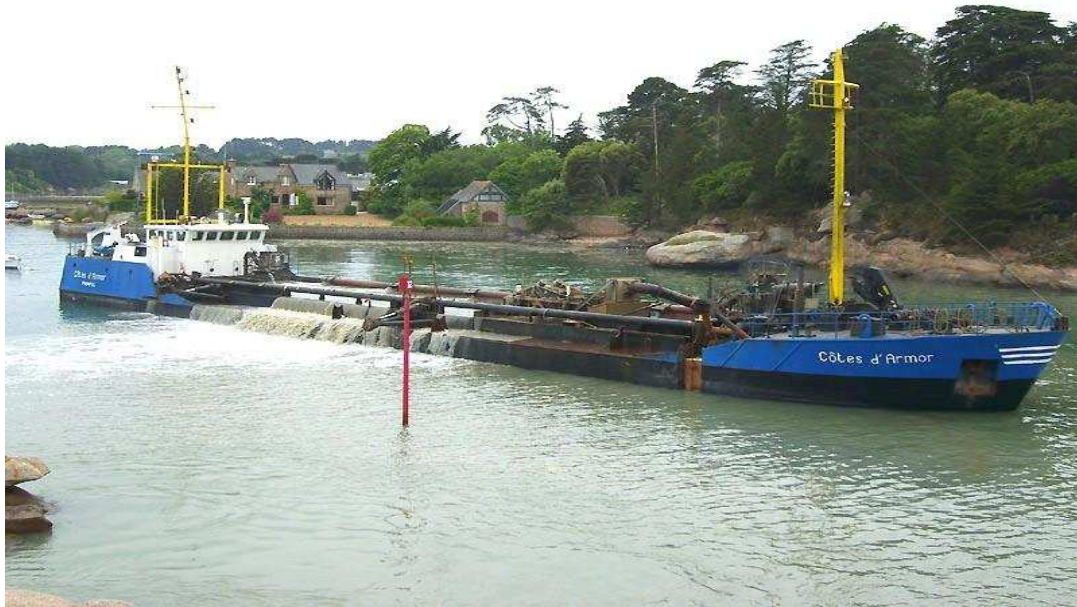
Figure IV-2 : Drague aspiratrice en marche (CoDISOD ; 2008).
