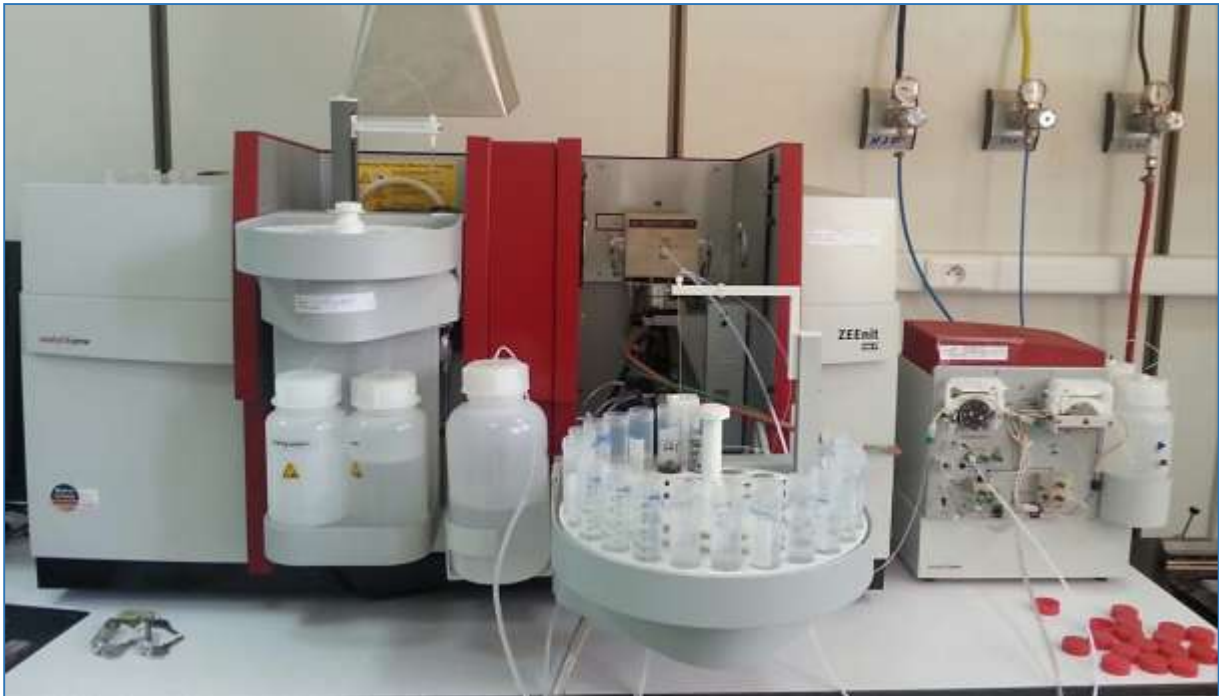
Figure 22 : L'appareil de spectrophotométrie par absorption atomique de marque analytikjena, modèle ZEEmit 700P
