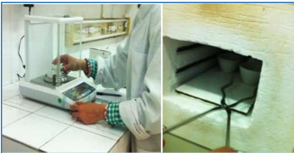
Figure 13 : Les étapes de la mesure de la MOP
