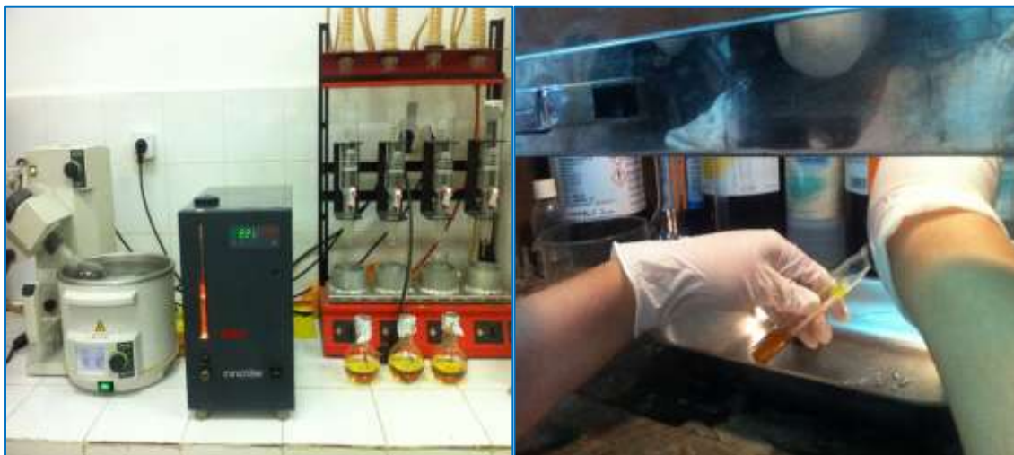
Figure 18 : Photo des étapes de l'extraction, concentration et traitement au mercure
