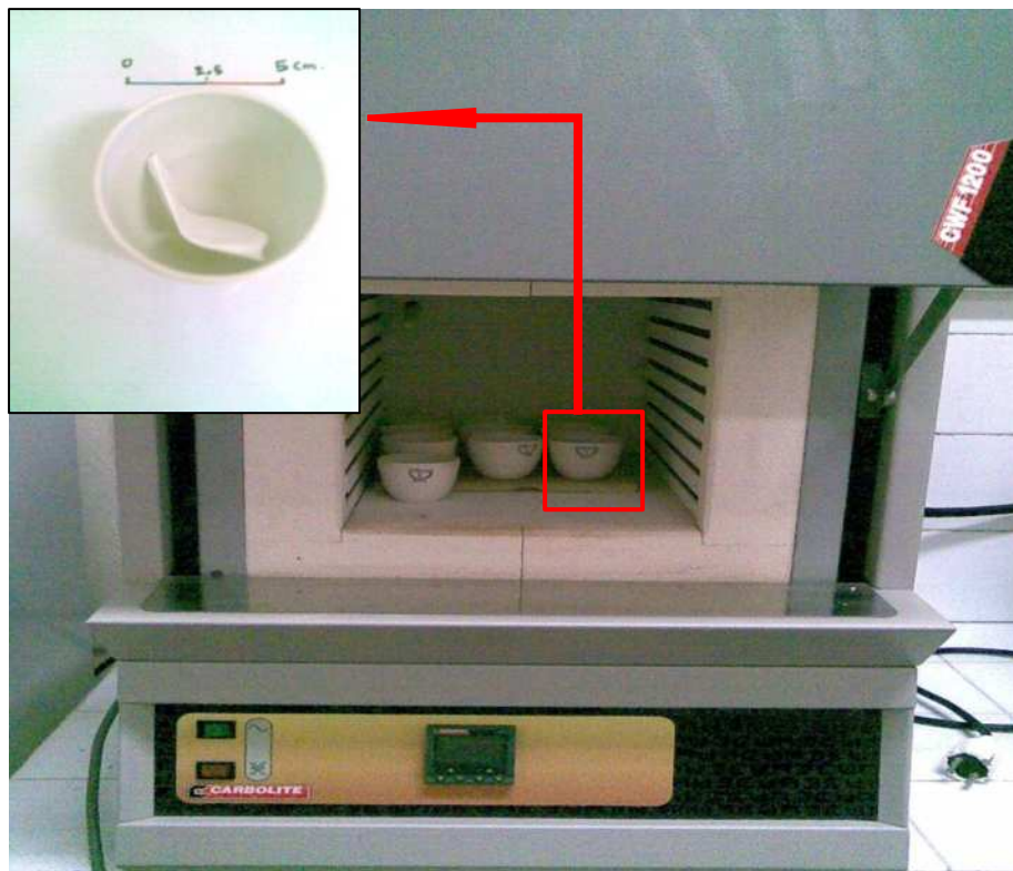
Figure II.23 : (A) four à moufle ; (B) creuset en porcelaine
