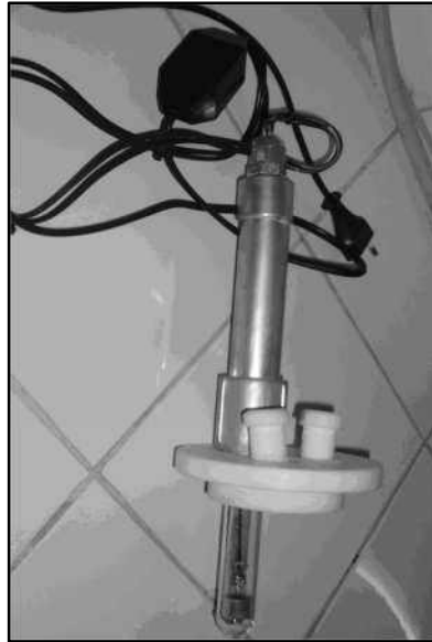
Figure II.7 : Lampe UV fixée au centre du couvercle
