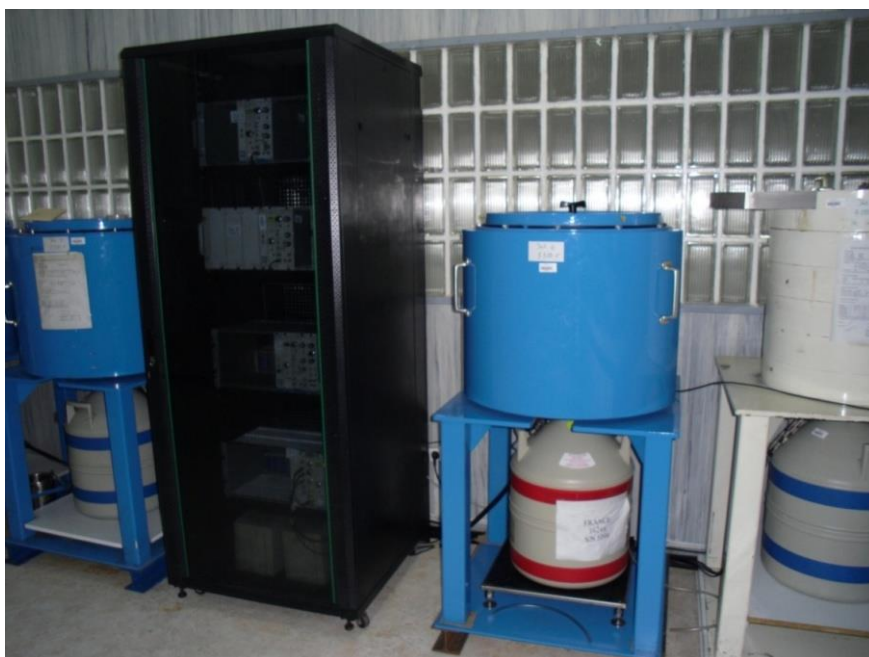
Figure 37 : Chaîne de la spectrométrie gamma GeHP du laboratoire de l'environnement du CRNA
