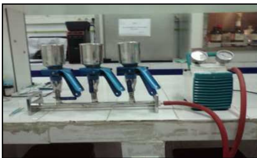
Figure III.14 : Rampe à filtration.
