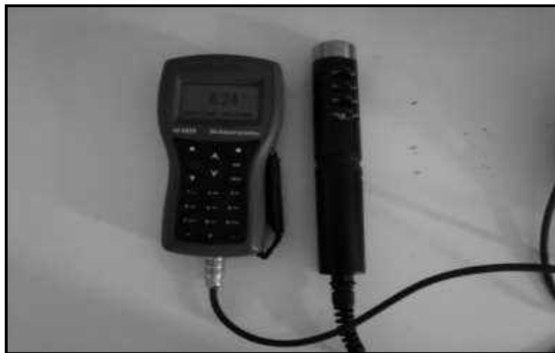
Figure III.13 : La sonde multiparamètre.
