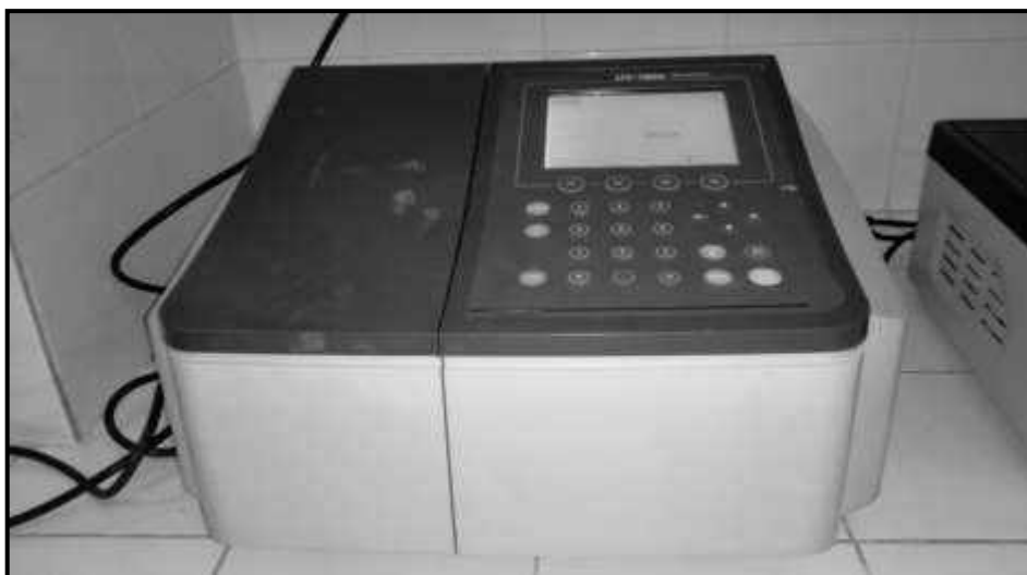
Figure III.21 : Le spectrophotomètre UV visible (UV-1800 SHIMADZU)
