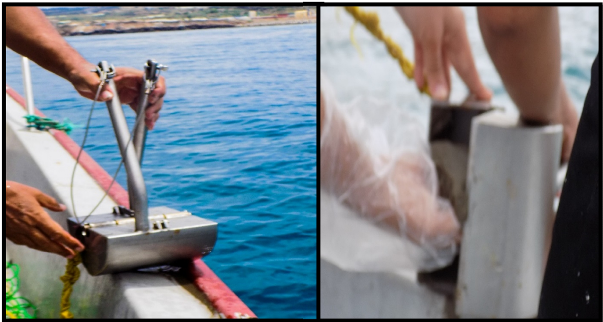
Figure 30 : prélèvement du sédiment par la benne Van Veen
