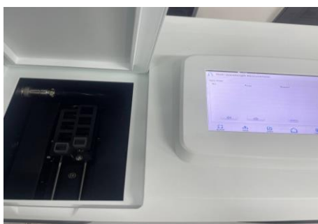
Figure 15. Lecture de l'absorbance à l'aide d'un spectrophotomètre multi-longueurs d'onde
