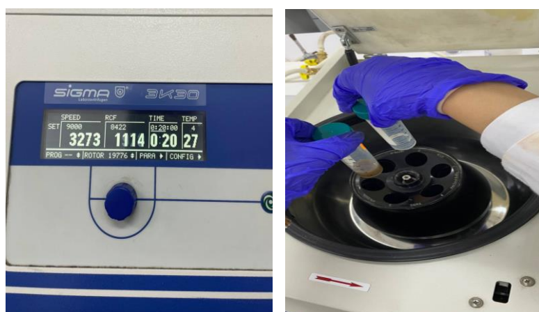
Figure 10. Images montrant l'homogénat obtenu centrifugé à 9000 tr/min pendant 20 minutes à 4 °C.
