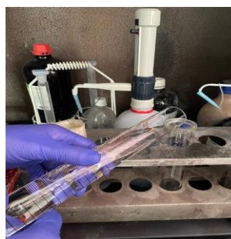
Figure 12. Étape de minéralisation des échantillons lors de la détermination de l'azote total par la méthode de Kjeldahl
