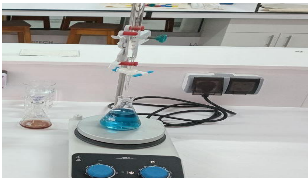
Figure 14. Titration du distillat avec de l'acide sulfurique
