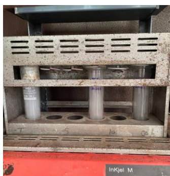
Figure 12. Étape de minéralisation des échantillons lors de la détermination de l'azote total par la méthode de Kjeldahl
