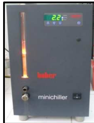
Figure N°7: Réfrigérant à eau «huber minichiller»
