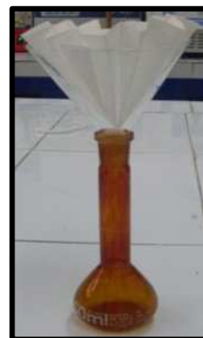
Figure N°9 : Filtration des résidus
