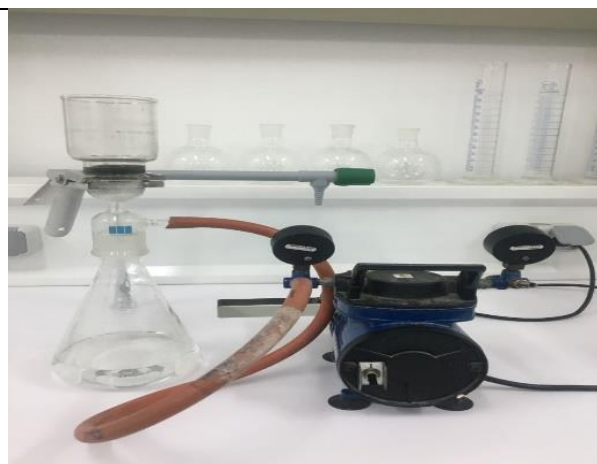
Figure IV.5: Dispositif de lavage des matériaux
