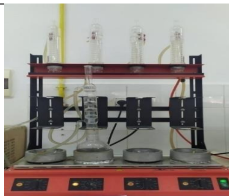
Figure IV.4: Dispositif pour l'activation à l'acide chlorhydrique
