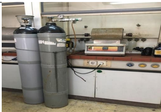
Figure IV.3: Four tubulaire avec jet d'azote
