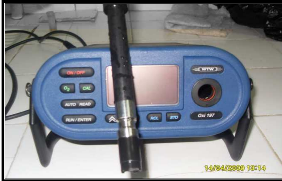
Photo 2 : Oxymètre du terrain
