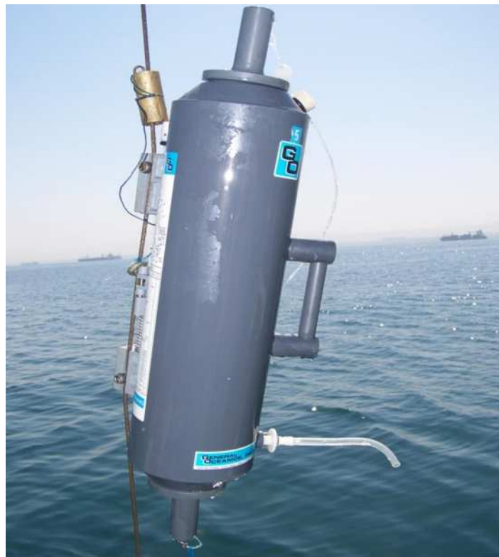
Figure 8 : bouteille de prélèvement de type Niskin (8L)
