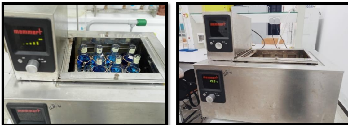
Figure II.8: adsorption de BM en agitateur muni d'un bain thermostaté (model Memmert SV 1422)
