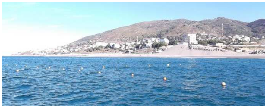
Figure 76 : Balisage surfacique chaque 10 mètre dans quatre directions
