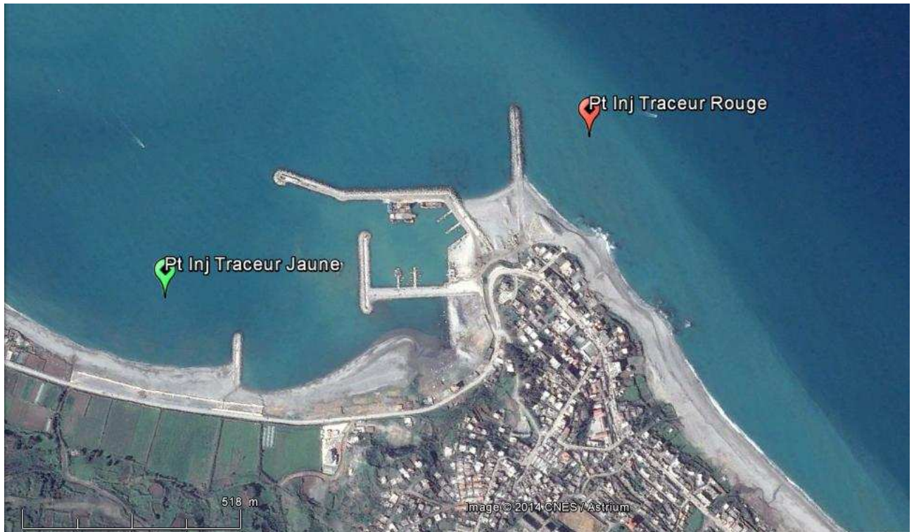
Figure 71 : Positions des points d'injection des deux traceurs fluorescents
