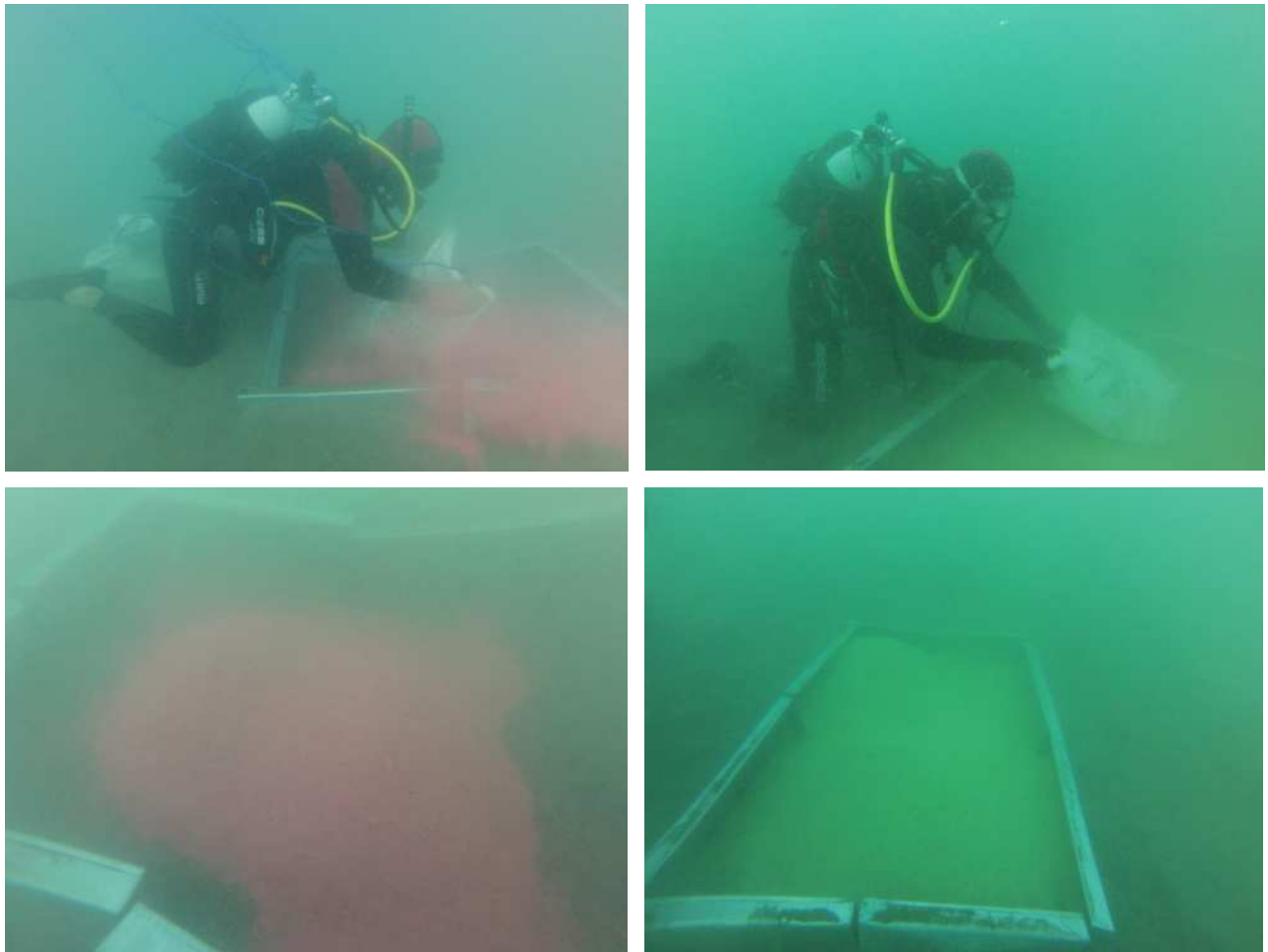
Figure 73 : Injection des traceurs Rouge à gauche et Jaune à droite
