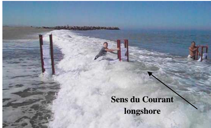
Figure 90 : Mesure des transferts sédimentaires dans la zone de déferlement de la houle à l'aide des pièges à sédiments unidirectionnels (Plage Nord) le 25-10-2014.
