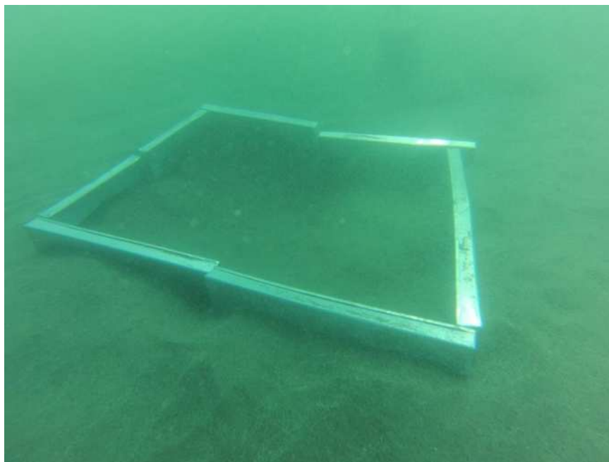
Figure 72 : Rectangle creusé sur le fond pour mettre en place le traceur
